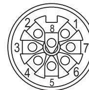
Цоколевка соединителя (вид со стороны монтажа)
