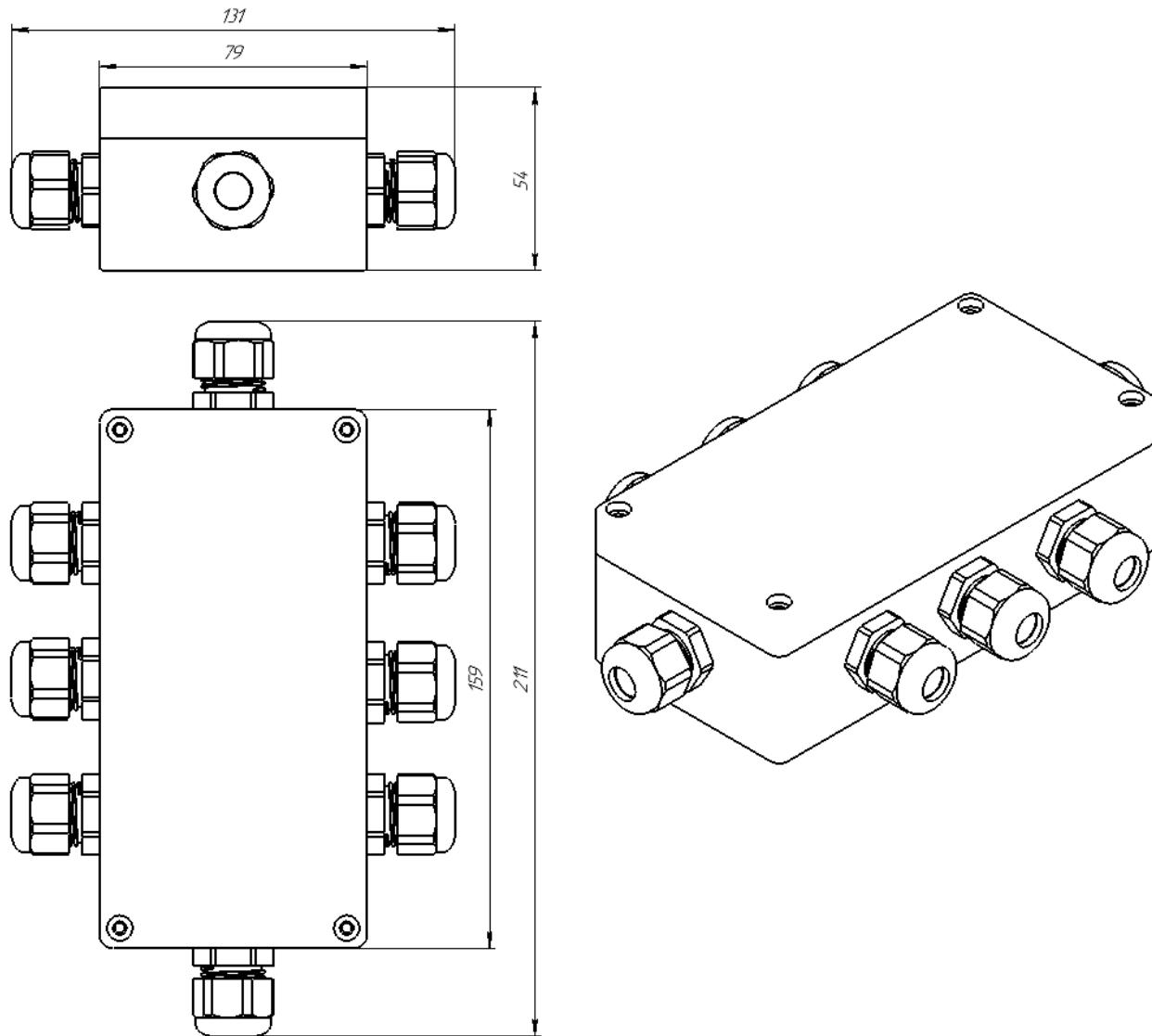
Рисунок А.1 – Габаритные и установочные размеры
