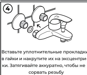
Вставьте уплотнительные прокладки в гайки и накрутите их на эксцентрики. Затягивайте аккуратно, чтобы не сорвать резьбу
