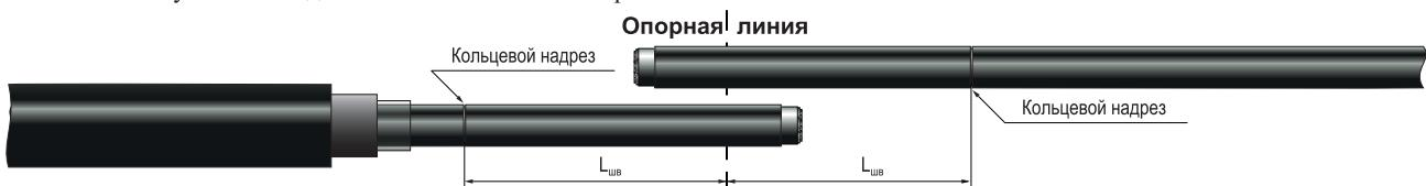
5.2. Наложите на обоих кабелях на бронеленты бандажи из 2-3 витков проволоки на расстоянии 50 мм от бандажей наложенных по покрову кабеля в сторону опорной линии. На расстоянии 5 мм сделайте кольцевые надрезы по лентам брони. Удалите бронеленты начиная от концов кабелей. Очистите оболочку на длине не менее 250 мм от среза брони. Ленты брони зачистите металлической щеткой до блеска.
