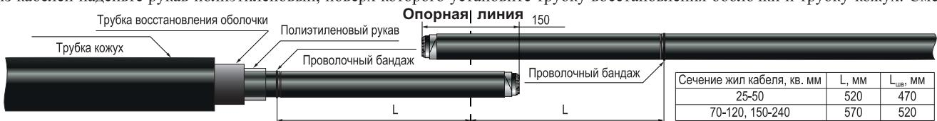
Для защитного покрова типа Шв, в зависимости от сечения жил кабеля, на расстоянии L<sub>шв</sub>, выполните кольцевой надрез по шлангу кабеля. Удалите шланг и очистите оболочку кабеля на длине не менее 250 мм от среза шланга.
