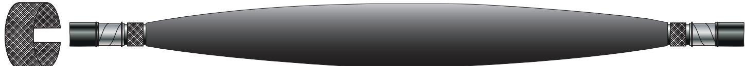
5.17.2. Плотно намотайте сетку медную луженую с 50% перекрытием от одной контактной пластины-терки до другой с наложением на них.
