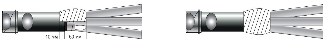
5.9. Наденьте на концы жил перчатки и с усилием надвиньте их до упора на корешки разделки кабелей. Последовательно усадите перчатки, начиная с основания, затем в направлении юбки. После чего усадите пальцы перчаток. Убедитесь, что после усадки на торцах юбки и пальцев появился клей-расплав.
