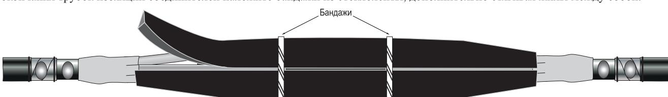
5.14. Намотайте стеклоленту ЛЭС на поверхность секторного межфазного заполнителя с 50% перекрытием от оснований пальцев перчатки одного кабеля до оснований пальцев перчатки другого кабеля. Намотку производите с усилием, стягивая жилы кабелей. Концы стеклоленты закрепите изолентой ПВХ.
