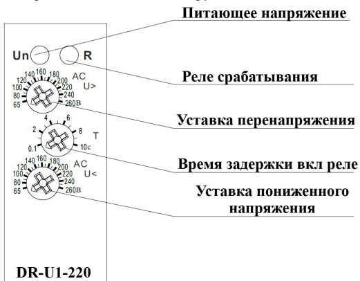
Рисунок 8 – Индикация и регуляторы однофазного реле напряжения.
