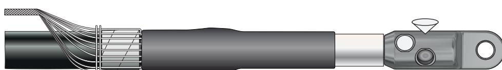
5.11. Остатком ленты «Герметик А» и, если имеется, дополнительной лентой из комплекта, заполните переход между наконечником и изоляцией жилы.
