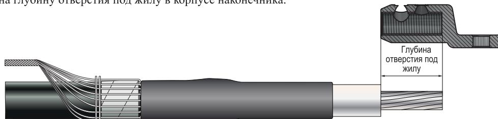
Установите на жилу болтовой наконечник. Болты плавно, без рывков, затяните до срыва головок, придерживая наконечник специальным приспособлением. Первым затягивается и срывается болт, находящийся со стороны кабеля.
