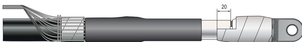
5.13. Оберните ленту герметика коричневого цвета из упаковки «Герметик Т-120» (-180, -360) по проволокам экрана, перекрывая бандаж и далее в сторону трубы стресс-контроля. Заполните герметиком переход между проволоками экрана и трубкой стресс-контроля.
