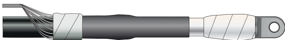
5.14. Установите антитрекинговую трубку, так чтобы наружный конец трубы полностью закрывал цилиндрическую часть наконечника. Усадите трубку, начиная с места среза полупроводящего слоя, затем в сторону наконечника. Потом в сторону экрана.
