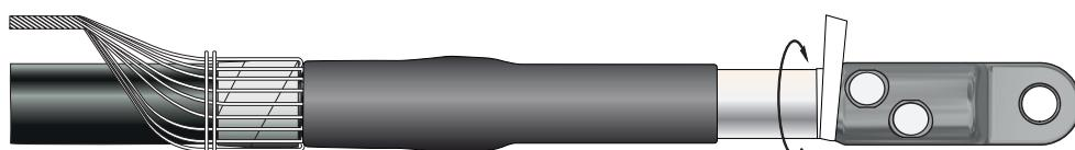
5.12. Равномерно, с перекрытием и натяжением намотайте на цилиндрическую часть наконечника ленту герметика коричневого цвета из упаковки «Герметик Т-120» (-180, -360) с заходом на изоляцию жилы на 20 мм.
