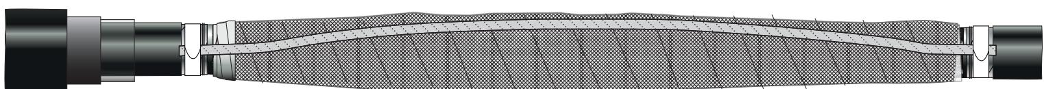
5.22. Оберните ленты коричневого цвета из упаковки «Герметик Т-360» вокруг внешнего покрова кабелей по торцам экрана на ширине 40-50 мм.
