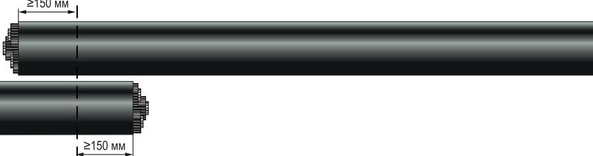
5.2. На один из кабелей наденьте последовательно рукав полиэтиленовый, короткую и длинную трубки-коухи. Сместите их в сторону.
