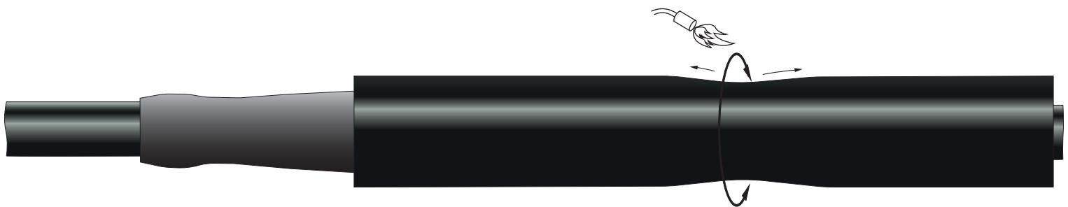
5.26. Монтаж муфты закончен. Дайте муфте остыть прежде, чем подвергать её каким-либо механическим воздействиям.
