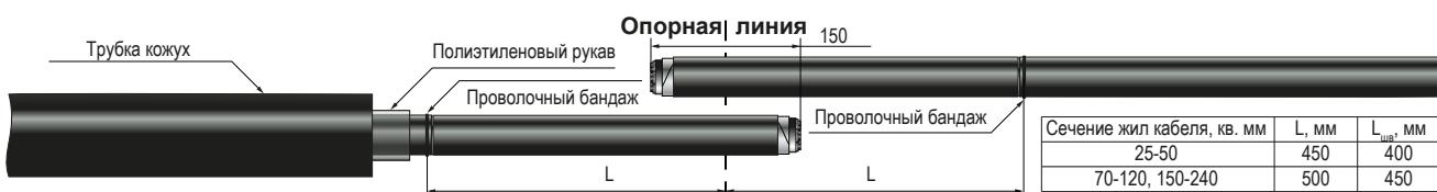
Для защитного покрова типа Шв, в зависимости от сечения жил кабеля, на расстоянии L<sub>шв</sub>, выполните кольцевой надрез и удалите шланг. Очистите оболочку кабеля на длине не менее 200 мм от среза шланга.
