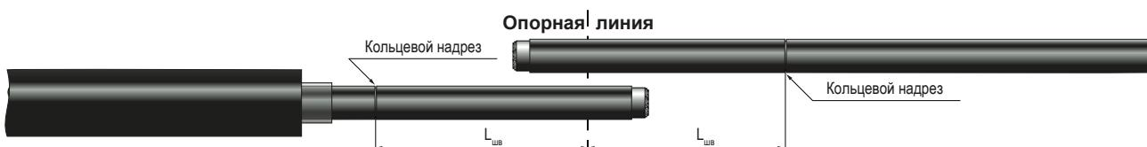
5.2. Для кабеля с броней наложите на обоих кабелях на бронеленты бандажи из 2-3 витков проволоки до расстояния 50 мм от бандажей, наложенных по покрову кабеля в сторону опорной линии. На расстоянии 5 мм сделайте кольцевые надрезы по лентам брони. Удалите бронеленты начиная от концов кабелей. Очистите оболочку на длине не менее 200 мм от среза брони. Ленты брони зачистите металлической щеткой до блеска.
