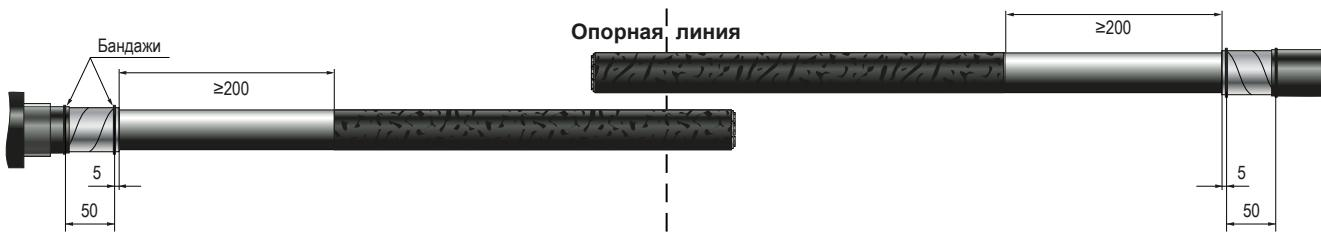
5.3. Для соединения оболочек кабелей жилой заземления залудите участки оболочек и бронелент каждого кабеля для пайки согласно рисунку.
