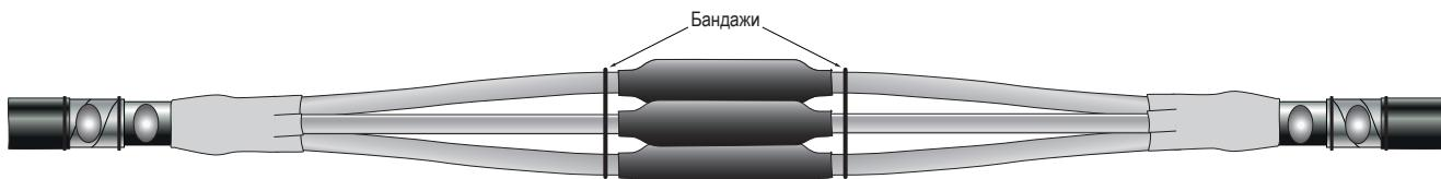
5.11. Вдоль муфты разместите жилу заземления. Распустите концы заземляющего провода на длине не менее 100 мм и закрепите их бандажами из 2-х витков проволоки на залуженных поверхностях бронелент и оболочки. Произведите пайку заземляющего провода к бронелентам и оболочке. Пайку к оболочке необходимо произвести на длине не менее 40 мм так, чтобы место пайки образовало гладкую выпуклую поверхность, при этом провод заземления должен быть насквозь пропитан припоеем для обеспечения герметичности.
