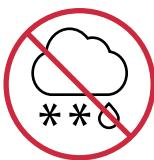
**Не допускать нанесения при неблагоприятных погодных условиях (осадки в виде снега, дождя, града). Убедитесь, что погодные условия позволяют наносить покрытие до полного его высыхания.**
