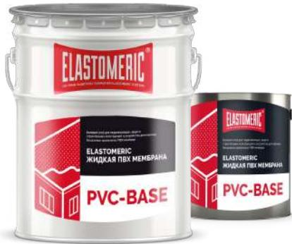
**ELASTOMERIC PVC-Base** — однокомпонентное покрытие на основании модифицированного ПВХ, термоэластопластов и нефтеполимерных смол для гидроизоляции и защиты заглубленных строительных конструкций, фундаментов, резервуаров, а также в качестве базового слоя на кровлях.
