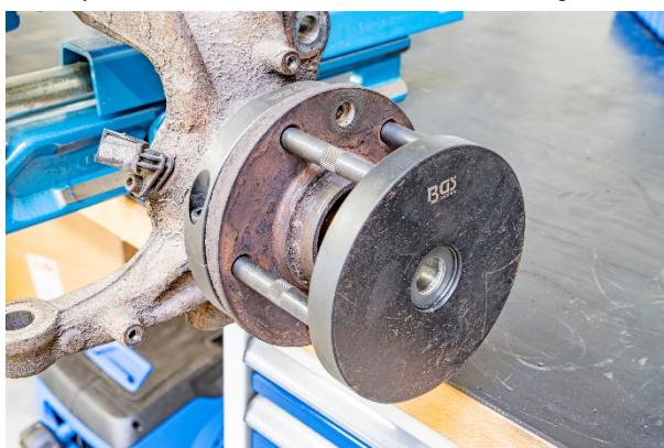
Прикрепите демонтажную пластину сбоку к приводному валу и проведите шпиндель с прикрепленной монтажной пластиной спереди через ступицу колеса и демонтажную пластину.
