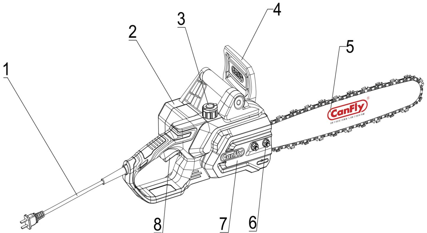
1. Сетевой кабель; 2. Задняя крышка двигателя; 3. Крышка масляного бака; 4 . Рычаг тормоза; 5. Пильная шина; 6. Гайка M8; 7. Торцевая крышка;
