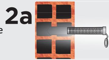
При монтаже в пустотелой конструкции вставьте в отверстие гильзу.
