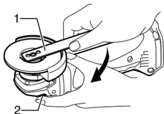
Рисунок 6 - Снятие рабочего диска для аккумуляторной угловой шлифовальной машине серии DLAG.
