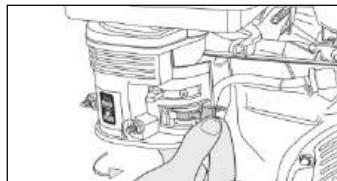
2. Закройте воздушную заслонку. При запуске прогретого двигателя закрывать заслонку не нужно.
