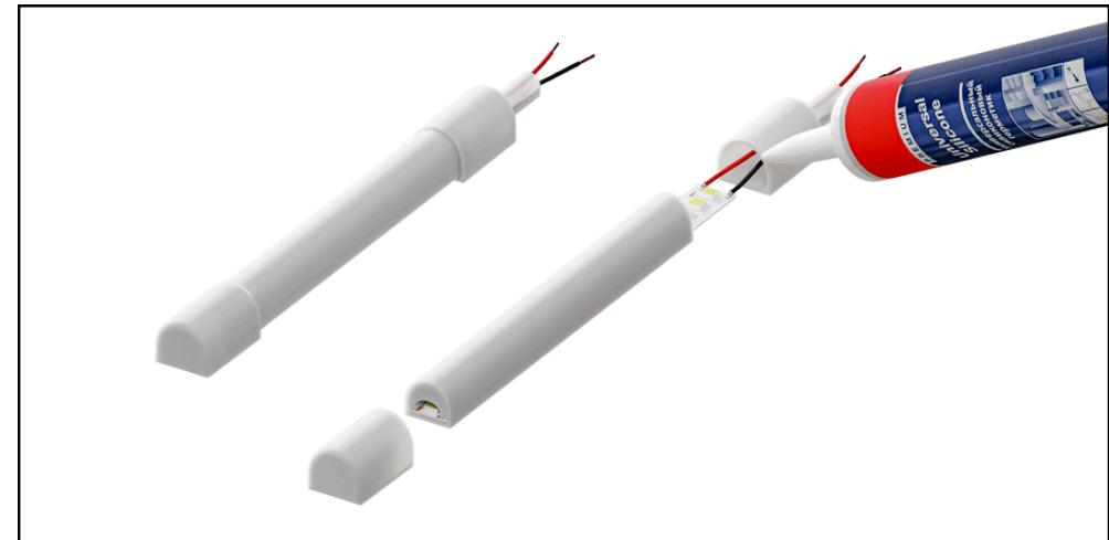
Силиконовая кабельная заглушка с отверстием под вывод провода и торцевая заглушка разработаны специально для светодиодной ленты серии NEON TERMO.
