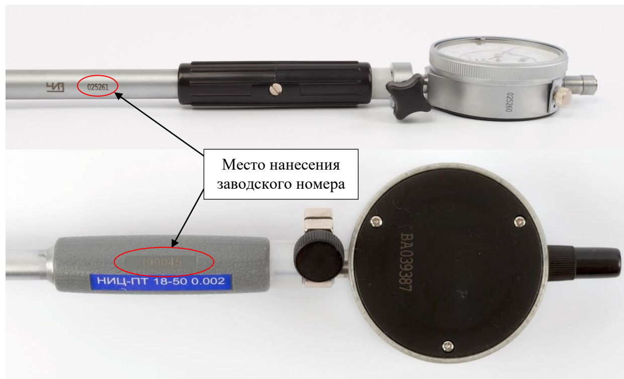
Рисунок 5 – Места нанесения заводских номеров на державке и удлинительном стержне нутромера
