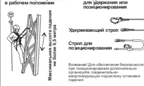
Рис. 11. Позиционирование в рабочем положении
