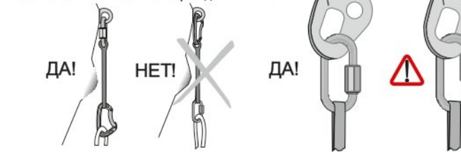
Рис. 6. Использование оттяжек с рапидами «Link 8»
