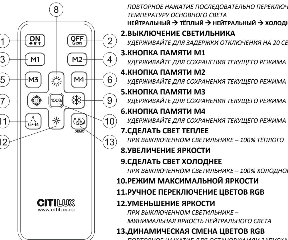
Инфракрасный пульт ДУ позволяет полноценно управлять всеми функциональными возможностями светильника. Для питания пульта применяются 2 батарейки формата AAA напряжением 1,5V. При снижении расстояния устойчивого управления светильником, замените батарейки на новые. Если предполагается длительный перерыв в использовании пульта, батарейки следует извлечь.
