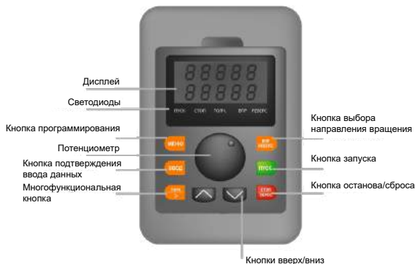
Рис. 5.1 Функции кнопок и светодиодов панели управления LCI
