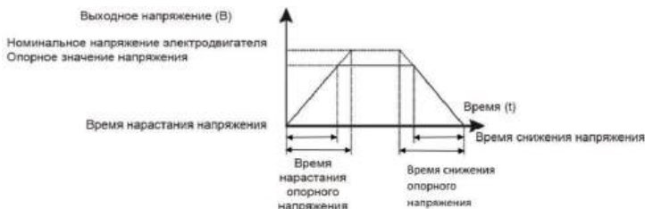
Рис.6.8 Время нарастания и снижения напряжения
