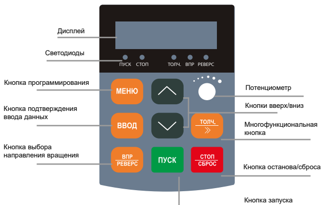
Рис. 5.2 Функции кнопок и светодиодов панели управления LCI(S)
