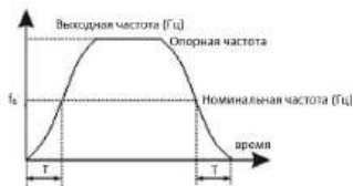
Рис. 6-3 Кривая S разгона/торможения В
