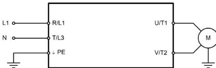
Подключение силовых клемм для моделей LCI-GY/PY-1
