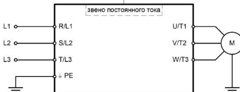
Подключение силовых клемм для моделей LCI-GY/PY-4(B)
