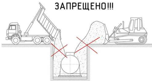
Рис 8. Пример НЕПРАВИЛЬНОЙ засыпки емкостей
