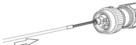
Оставшийся конец канала обрежьте при помощи специального резака или острого ножа. Будьте осторожны, не раздавите и не погните его. При установке направляющей спирали, спираль обрезают со стороны наконечника. После установите на горелку сварочный наконечник, диффузор и сопло.
