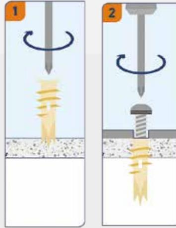
1. Установите KLA с помощью отвертки или шуруповерта.
