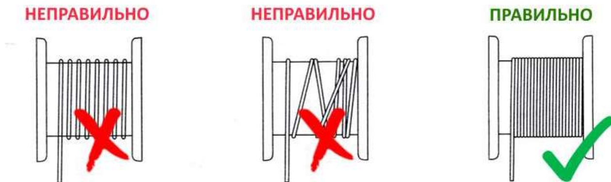
Рисунок 3. Намотка троса на катушку.
