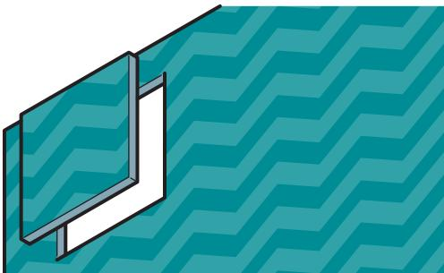
Аккуратно вырежьте в финишном покрытии отверстие по размерам регулировочной рамки. Сохраните вырезанный участок покрытия.
