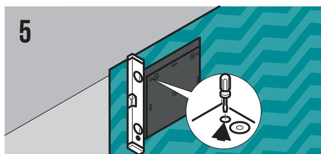
Используя регулировочные винты, выставьте рамку вровень с верхним краем финишного покрытия.
