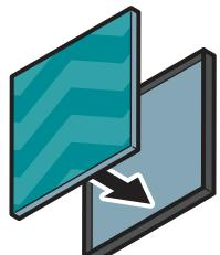
Нанесите клей на лоток и приклейте подготовленный элемент финишного покрытия. Готово!
