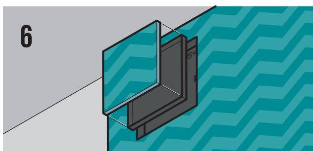
Вырежьте декоративный элемент для вставки в лоток в соответствии с геометрией и формой финишного покрытия.
