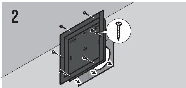
Установите корпус решетки в отверстие в черновой стене. Закрепите корпус винтами.
