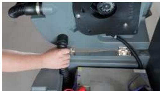
Шаг 3: вставьте коническую горловину всасывающей трубы в отверстие бака для сточных вод, а другой конец трубы – во всасывающее отверстие скребка.
