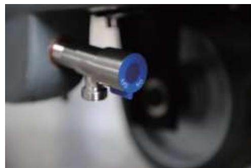
Перед использованием машины закройте водяной клапан и залейте чистую воду в бак для воды. Обращайте внимание на качество воды, чтобы предотвратить засорение трубы.
