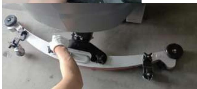
Шаг 2: пропустите крепежный винт скребка через проушину штатива и затяните его пластиковой ручкой.
