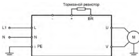
Рисунок 3.2 – Схема силовых подключений для моделей NCI-GY/PY-1B
