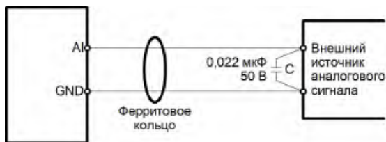
Рисунок 3.12 – Схема подключения проводов к аналоговому входу (при воздействии сильных помех)
