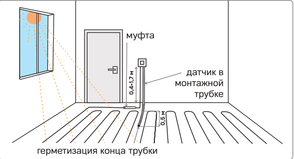
Рисунок 1. Монтаж терморегулятора и теплого пола
