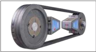
图4 激光单元装到皮带轮槽的示意图
