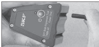
Рис 2 Установка и удаление V-направляющих
