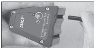
Fig 2 Ajustement ou retrait des guides V
