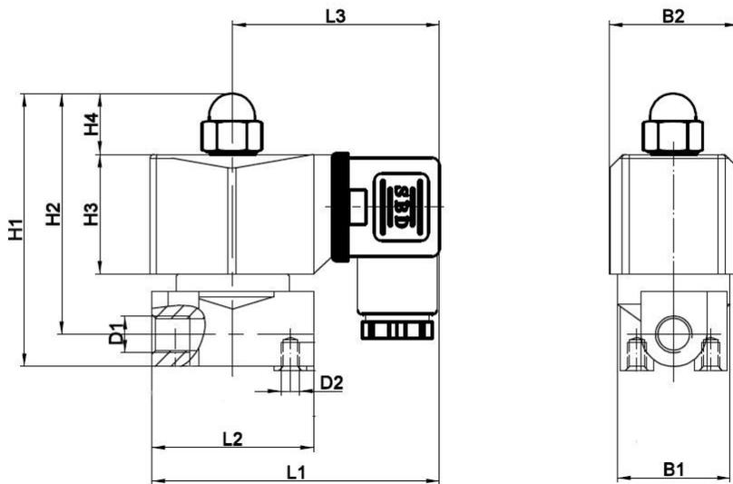
Рисунок 2 – Размеры клапанов VS2W-100/VS2W-300 Ду6-8 корпус латунь
