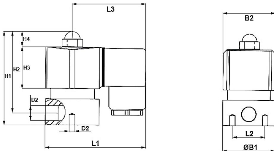
Рисунок 1 – Размеры клапанов VS2W-101/VS2W-301 Ду6-8 корпус нержавеющая сталь 304
