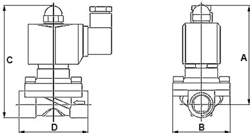
Рисунок 3 – Размеры клапанов VS2W-300(1) Ду10-50
