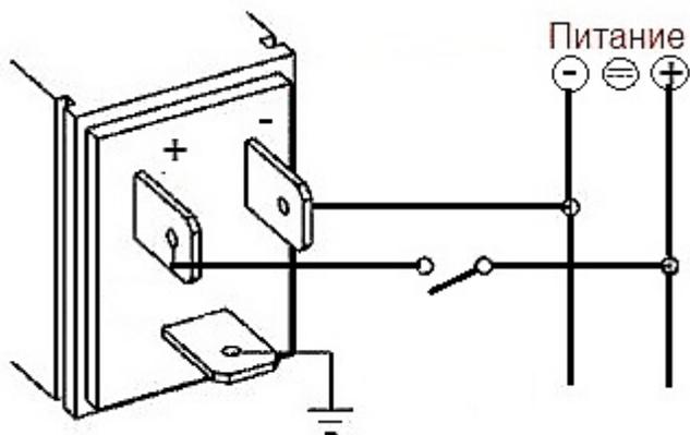
Рисунок 6 – Схема подключения на постоянное напряжение
