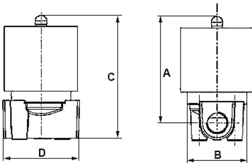
Рисунок 4 – Размеры клапанов VS2W-100(1) Ду10-50
