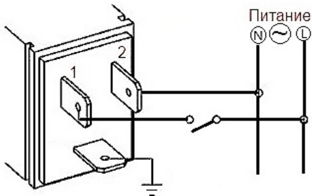
Рисунок 5 – Схема подключения на переменное напряжение
