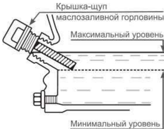
Рис. 4 Проверка уровня масла в картере
