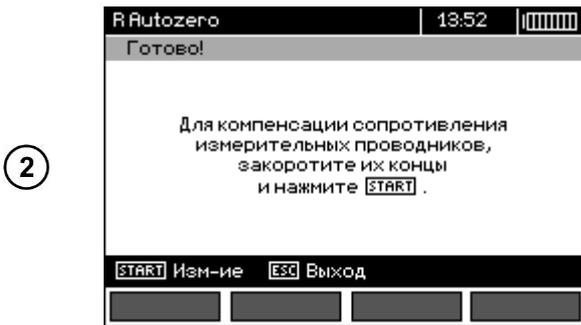
Следуйте инструкциям на экране дисплея.
