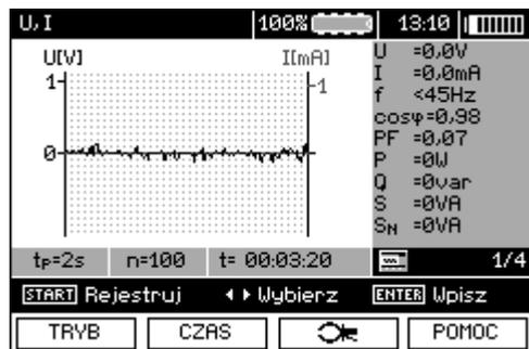
Используйте клавиши **◀ ▶** для навигации по строке **МЕНЮ**. Нажмите клавишу **F3** **🔍** для выбора типа токовых клещей.
