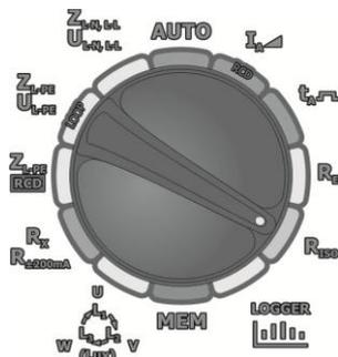
Установите поворотный переключатель режимов работы в положение **R<sub>iso</sub>**.
