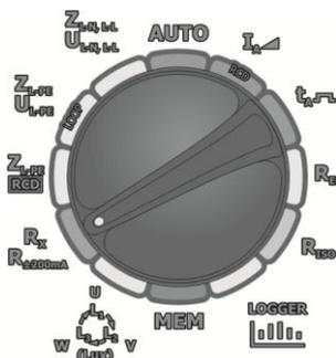
Установите поворотный переключатель режимов работы в положение **R<sub>x</sub> R<sub>±200mA</sub>**.
