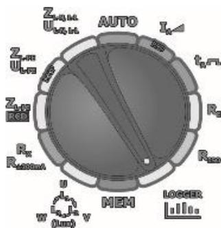
Установите поворотный переключатель режимов работы в положение **LOGGER**.
