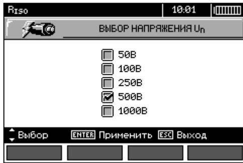
Клавишами ▲ и ▼ установите требуемое значение измерительного напряжения и подтвердите выбор нажатием клавиши **ENTER**.
