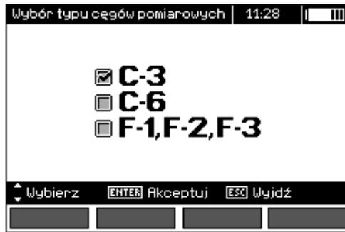
Используя клавиши ▲ и ▼, установите необходимый тип токовых клещей и подтвердите нажатием клавиши **ENTER**.
