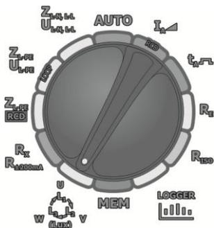
Установите поворотный переключатель режимов работы в положение  $w$  (Lux).
