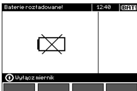
Аккумуляторы/батарейки полностью разряжены, измерения невозможны.
