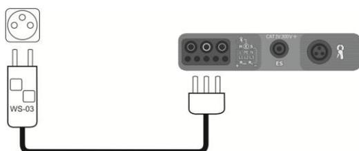
Подключите кабель WS-03 или WS-04 к проверяемой розетке.
