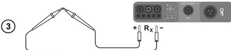
Для компенсации сопротивления измерительных проводов закоротите их щупы, а затем нажмите клавишу **START**
