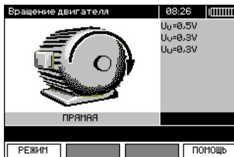
Вращение против часовой стрелки: подключение к клеммам L1, L2, L3 двигателя соответствующих фаз L1, L2, L3, приведет к вращению двигателя в направлении, обратном тому, в котором был повернут вал в ходе теста.
