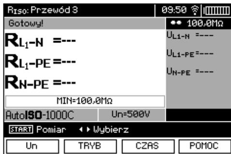
Нажмите клавишу **F1** **U<sub>N</sub>** для выбора измерительного напряжения **U<sub>N</sub>**.
