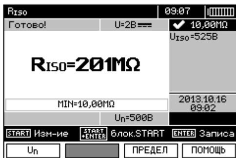
После окончания измерения сравните результат на дисплее с выставленным значением симулятора СК-1 согласно собранной схеме.
