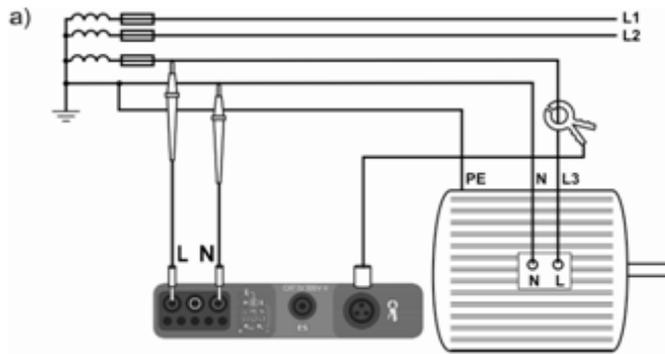
Вариант подключения токовых клещей
