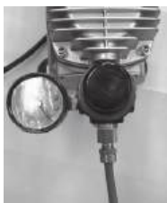
Рис.5. Подключение компрессора AP-2 к азрационной колонне
