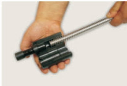
2. Помещаем отрезок трубы в вальцеватель
