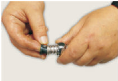
6. Устанавливаем резиновую прокладку
