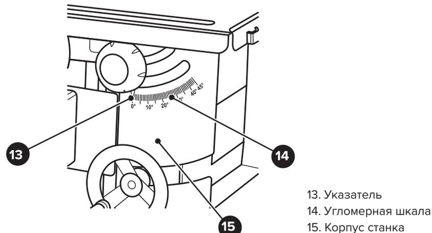
Рисунок 2 — Элементы настройки станка
