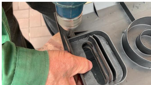
4. Высверливаем отверстия под саморезы для крепления переходника
