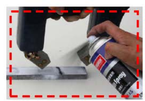
4. Нанесите черную магнитную суспензию SM-15
