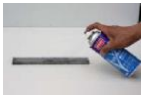
Очистите поверхности очистителем Mega Check
