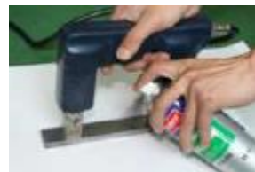
Распыляйте люминесцентную магнитную суспензию (FM-25)
