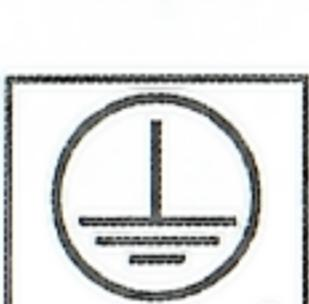
Класс 1 защиты от поражения электрическим током (заземление). Желто-зеленый провод светильника соединить с проводом заземления
