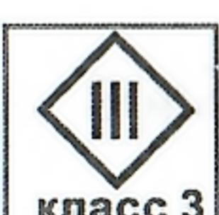
Класс 3 защиты от поражения электрическим током (безопасное низкое напряжение)
