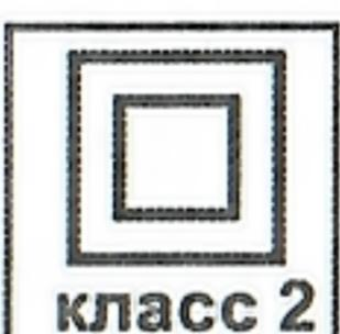
Класс 2 защиты от поражения электрическим током (усиленная изоляция). Не соединять светильник с заземлением.
