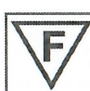
Светильник пригоден для монтажа на поверхностях с низкой огнестойкостью
