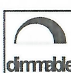
Светодиодный светильник можно подключать к внешнему диммеру. Если знак отсутствует, подключать к внешнему диммеру нельзя
