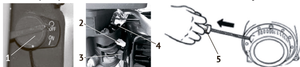
1 – Выключатель зажигания; 2 – Рычаг воздушной заслонки; 3 – Топливный кран; 4- Рычаг дроссельной заслонки; 5 – Рукоятка ручного стартера.
