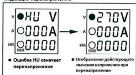
Рис. 3 – Индикация перенапряжения / пониженного напряжения
