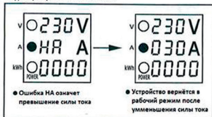
Рис. 4 – Индикация превышения силы тока / режимов отображения кВт·ч, кВт, Pf, Hz
