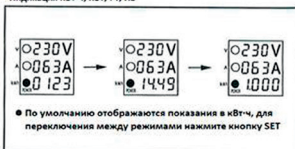
Рис. 4 – Индикация превышения силы тока / режимов отображения кВт·ч, кВт, Pf, Hz
