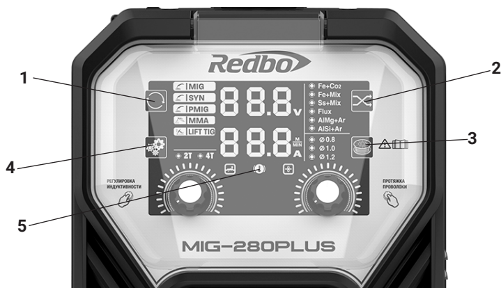
1 - выбор режима сварки; 2 - кнопка выбора использования проволоки в среде газа/без газа; 3 - кнопка выбора диаметра проволоки; 4 - выбор функции 2Т/4Т; 5 - индикатор термозащиты рис.1б
