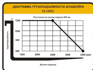
Рисунок. 4. Диаграмма грузоподъемности штабелера.
