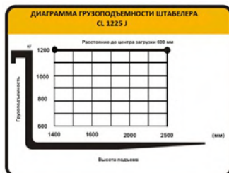
Рисунок. 4. Диаграмма грузоподъемности штабелера.
