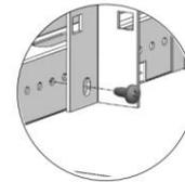
Фиксация 2-х или 4-х монтажных направляющих. На каждую необходимо по 2 винта М5
