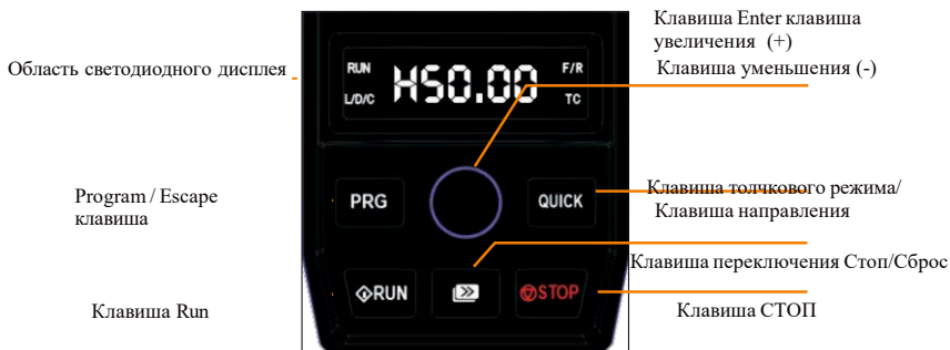
Рисунок 4-1 Встроенная светодиодная панель управления цифровым дисплеем (стандартная конфигурация, на съемной панели)
