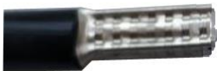
Рисунок 6.1 – Обжим провода СИП наконечником НШВ 16-18
