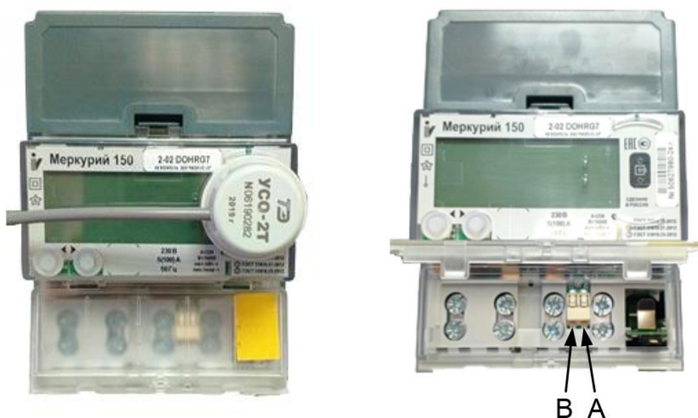
Рисунок 6.5 – Расположение оптической головки (слева) и назначение контактов для подключения интерфейса RS485 (справа)
