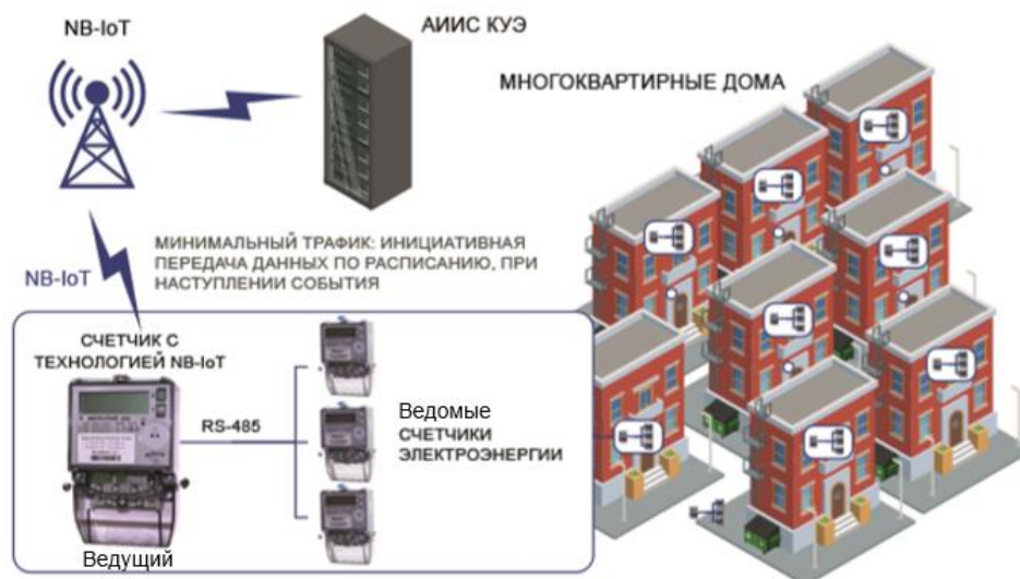
Рисунок 4.5 – Схема работы счетчика NB-IoT в составе АИИС КУЭ
