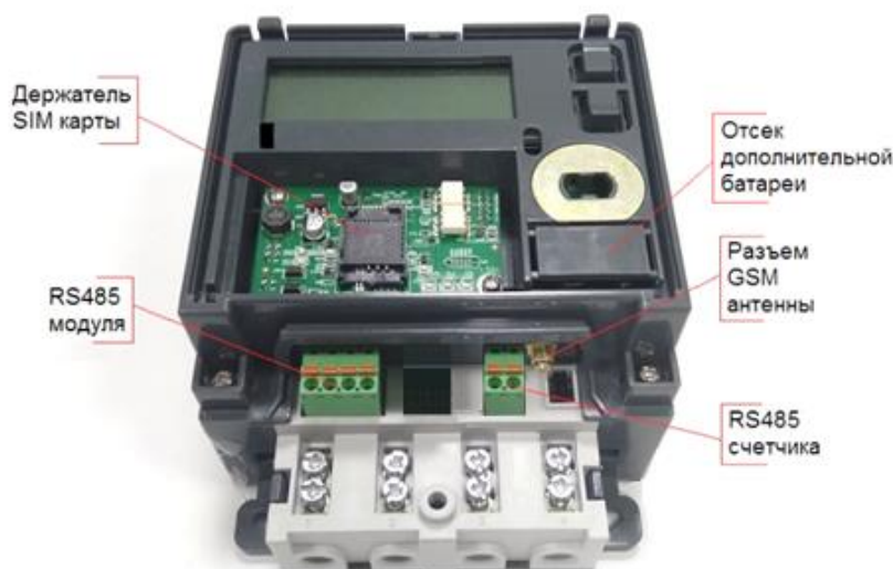
Рисунок 5.4 – Элементы подключения счетчика «Меркурий 204»
