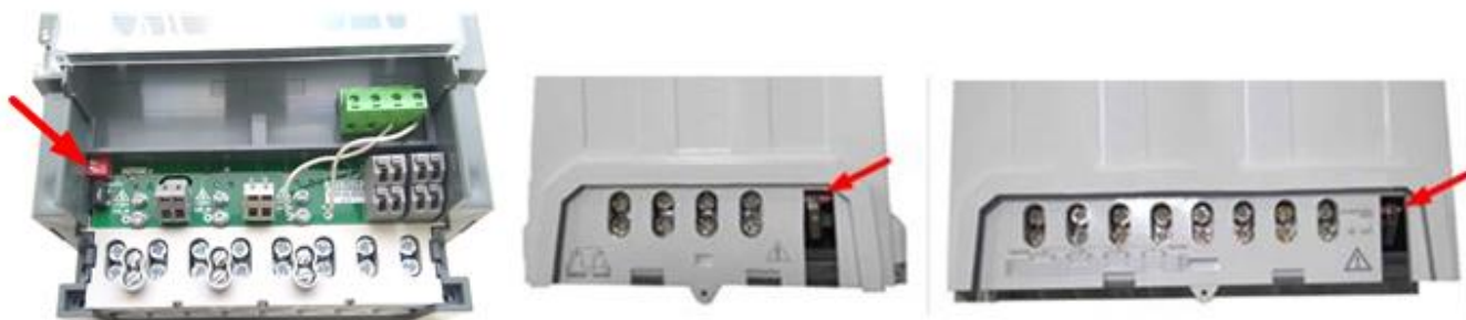
Рисунок 4.2 – Расположение переключателя блокировки управления нагрузкой счетчиков «Меркурий 234» (слева) и «Меркурий 208», «Меркурий 238» (справа)
