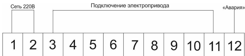
Рисунок 8 - Схема подключения клемм на ШУЭП 1 000.000.220 basic и ШУЭП 2 000.000.220
