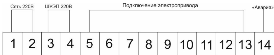
Рисунок 10 - Схема подключения клемм на ШУЭП 4 000.100.220
