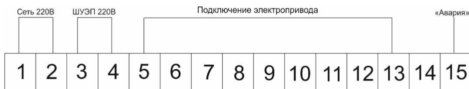
Рисунок 11 - Схема подключения клемм на ШУЭП 5 000.110.220
