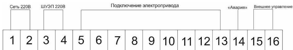
Рисунок 9 - Схема подключения клемм на ШУЭП 3 001.000.220
