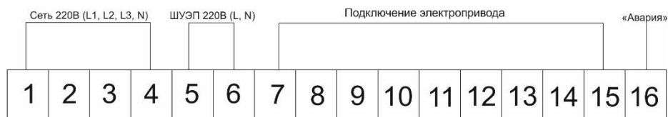
Рисунок 3 - Схема подключения клемм на ШУЭП-10 000.100.380 с функцией аварийного открытия/закрытия
